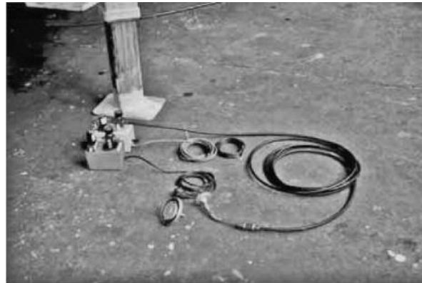
Imagen 8: Bomba de vacío para tanques hidráulicos.
